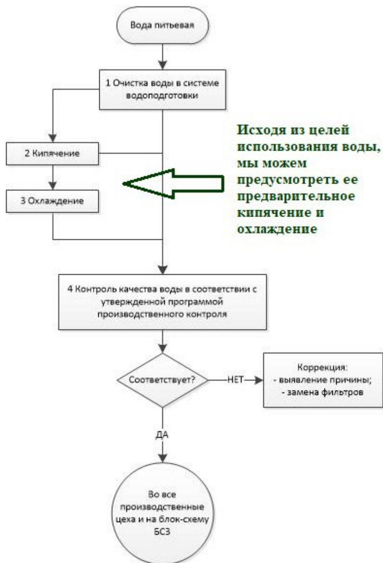
Рисунок А.7 - Пример блок-схемы подготовки воды к производству
